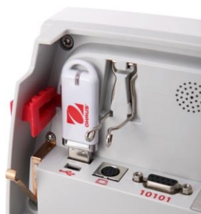
Connexions de l'interface à l'arrière du terminal.
